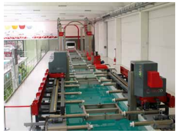
Der voll funktionsfähige Prototyp einer KTL bietet Kunden im Technikum von Geico vielfältige Optionen zum Austesten der Wunschkonfiguration.
