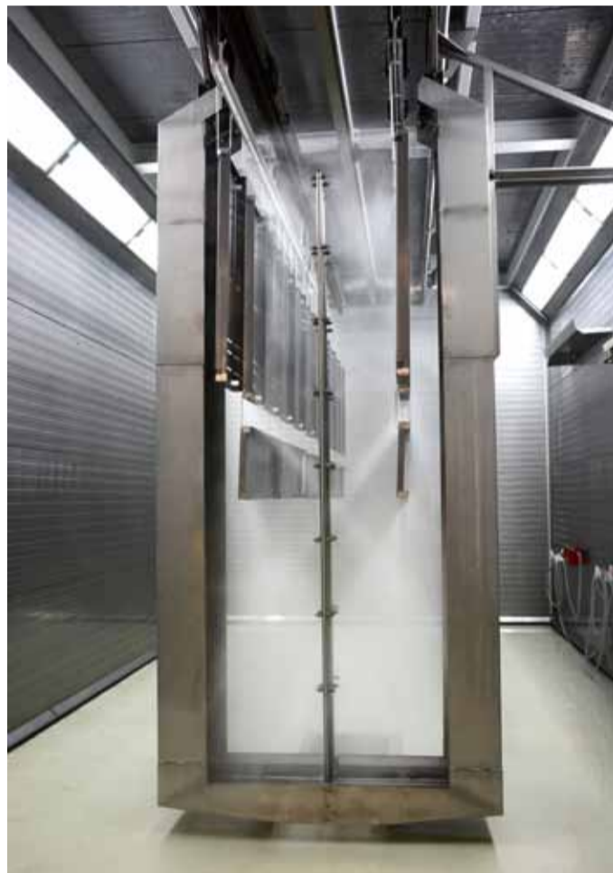
Mit dem fahrbaren Sprühkranz sind zwei separate vollautomatische Vorbehandlungslinien für Stahlteile sowie Werkstücke aus Aluminium und verzinktem Stahl möglich. Quelle (zwei Fotos): Meeh
