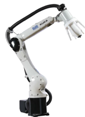
Das System besteht aus einem sechssachsigen Kleinroboter, der mit modernster Lack-Applikationstechnik ausgestattet ist und individuell konfiguriert wird.
