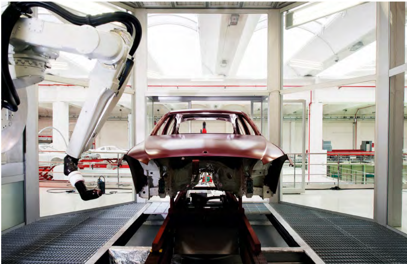
Der Skid mit der Karosserie fährt in die Kabine, bleibt in der Mitte stehen und wird mit einem Drehteller vom Fördersystem gehoben. Für die Lackierung bewegen sich Roboter und Karosserie gegenläufig. Quelle (drei Bilder): Geico Taiki Sha
