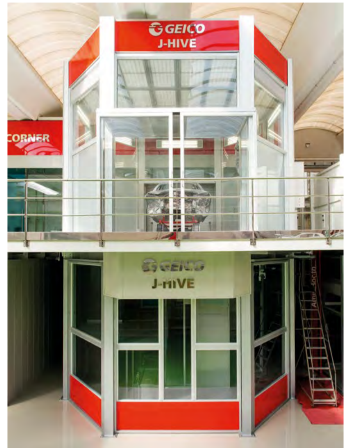
Durch den achteckigen Grundriss ist es möglich, Tore und Roboter beliebig anzuordnen.
